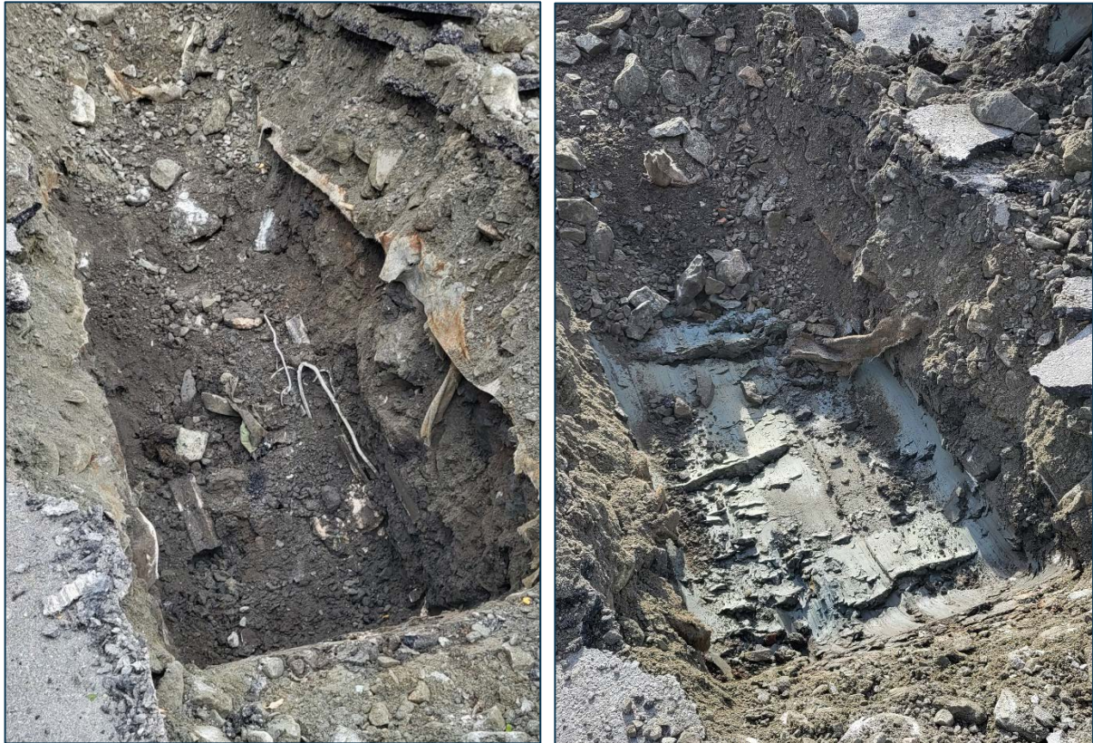
Figur 4. PG2202 (tv) där fyllning innehållande betong, armering och asfalt noterats ner till ca 1,8 m. PG2204 (th) med fyllning 0,4 m på naturligt avsatt lera.
